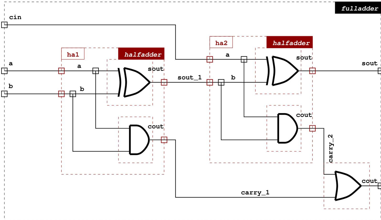
Un élément de base d'un additionneur.
