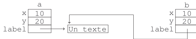
FIG. 2 – Copie « superficielle » d'un objet
