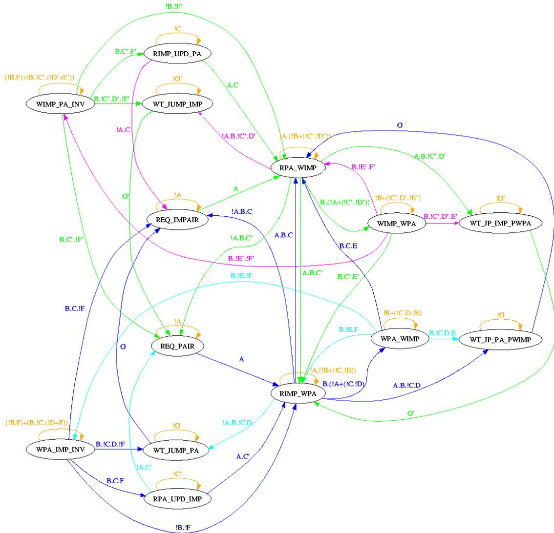
Figure A-26 - Automate d'état du module Fetch.
