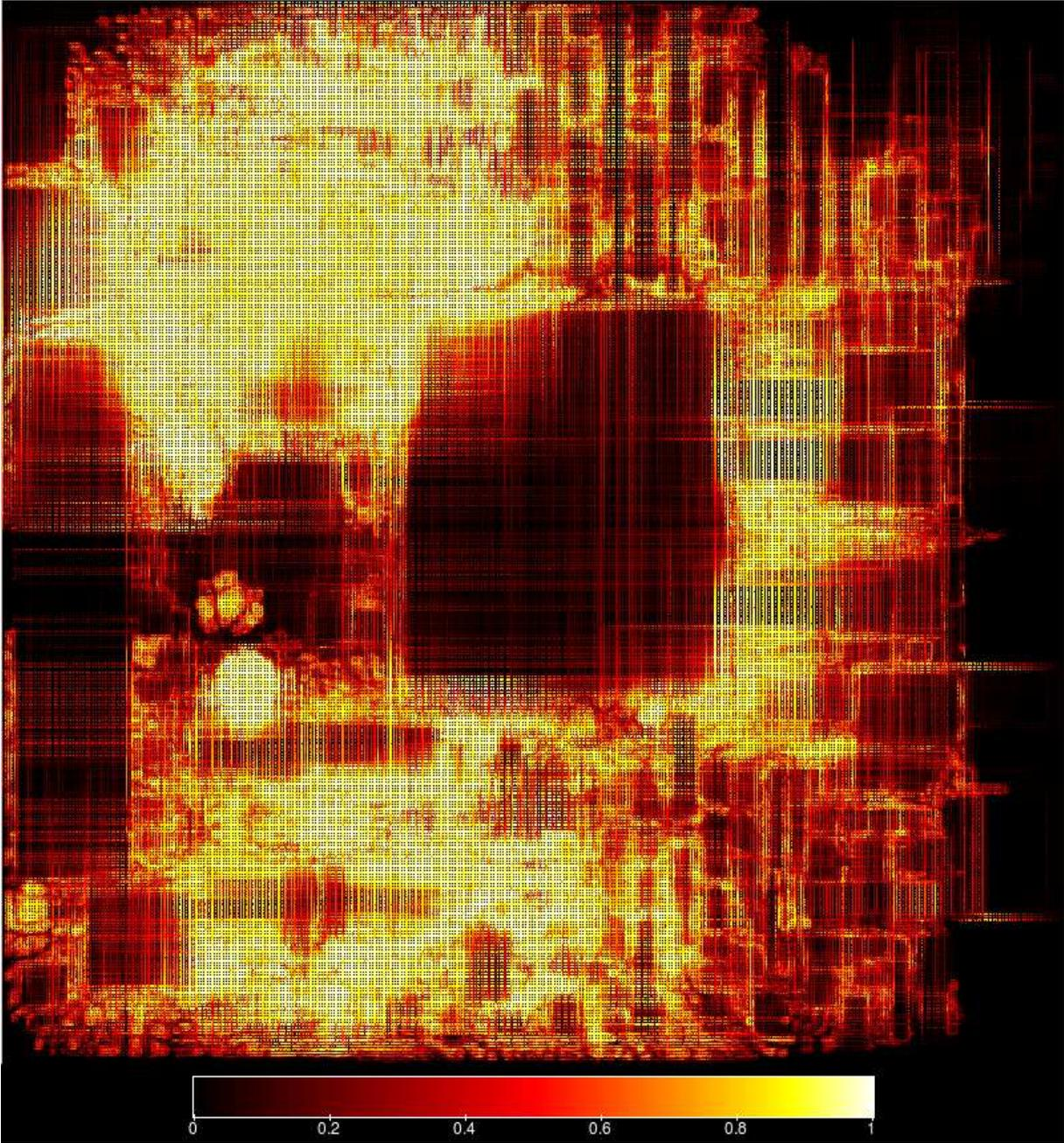
FIGURE C.39 – Carte de congestion du circuit *adaptec5* routé par KNIK
