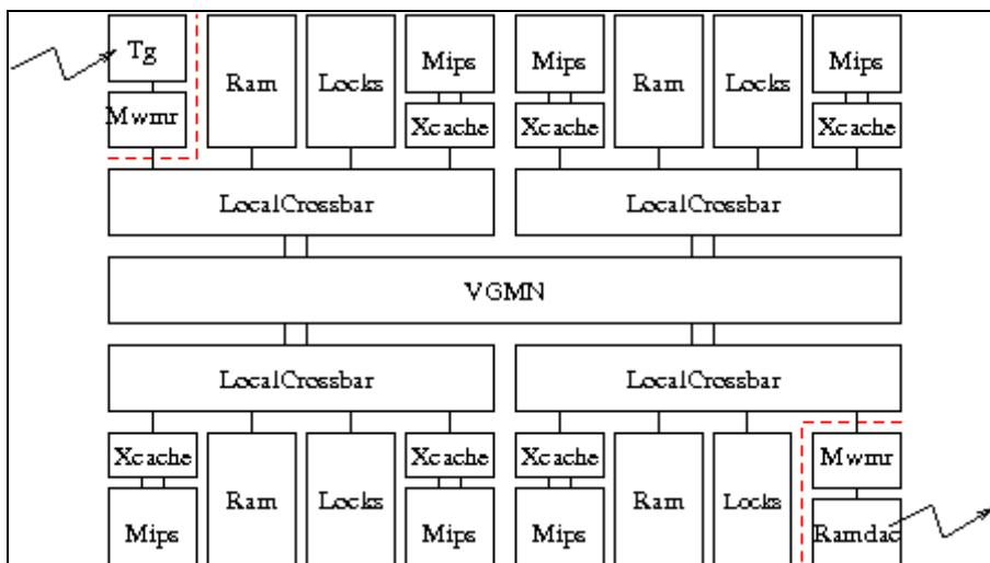
Chaque sous-système constitue un *cluster*, et contient des processeurs, de la mémoire, et dispose de son propre mécanisme d'interconnexion local.
