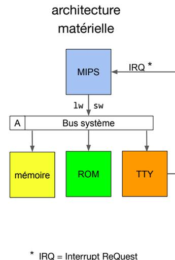
Ce schéma représente l'architecture de principe de l'ordinateur.
