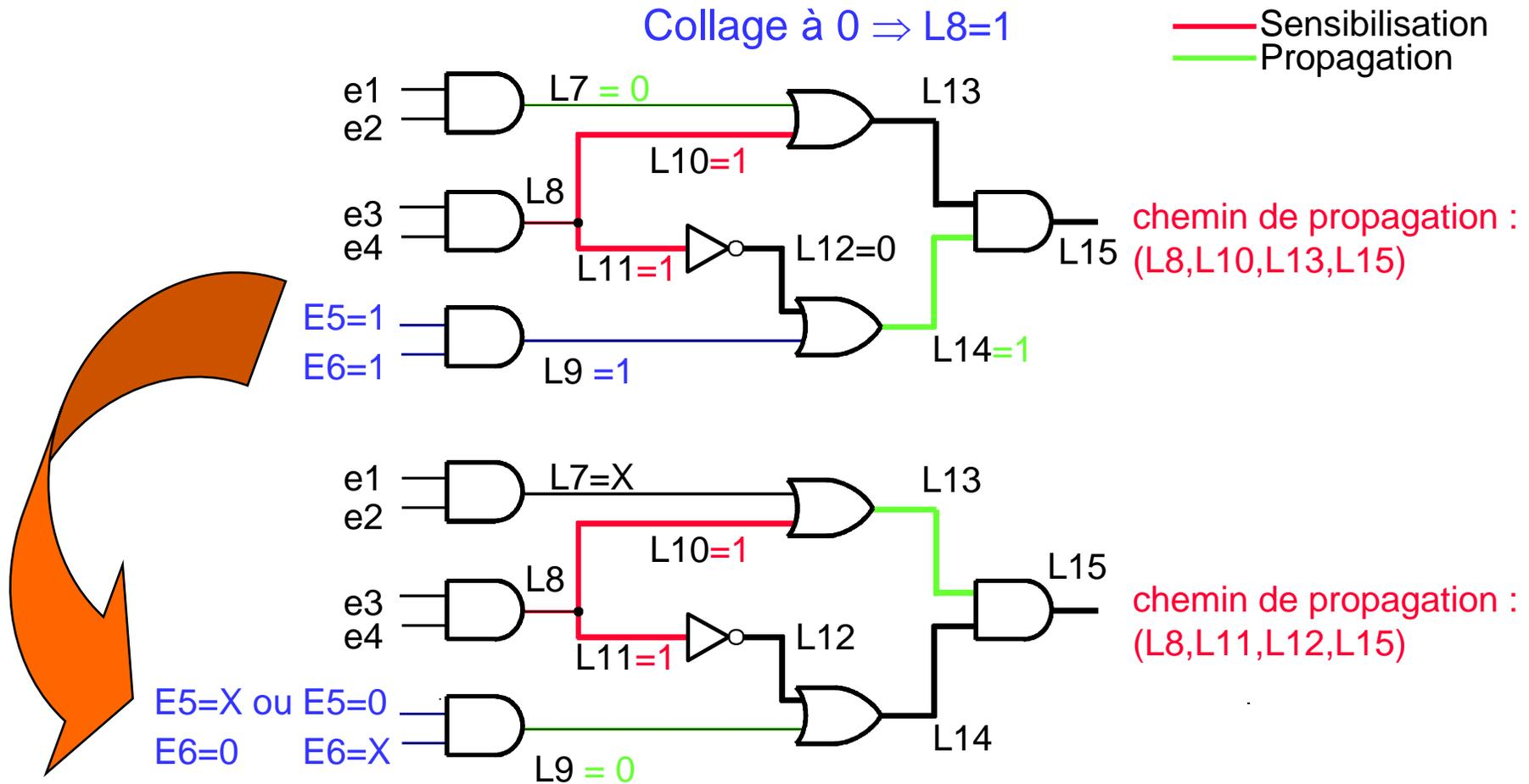
Les chemins de propagation ne peuvent être sensibilisés simultanément
