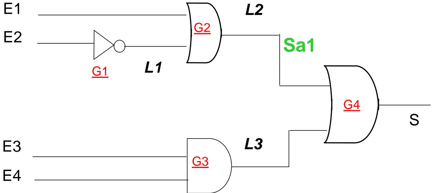
On veut trouver le vecteur permettant de détecter le collage a 1 de l'équipotentielle L2 ( Sa1 de L2)
