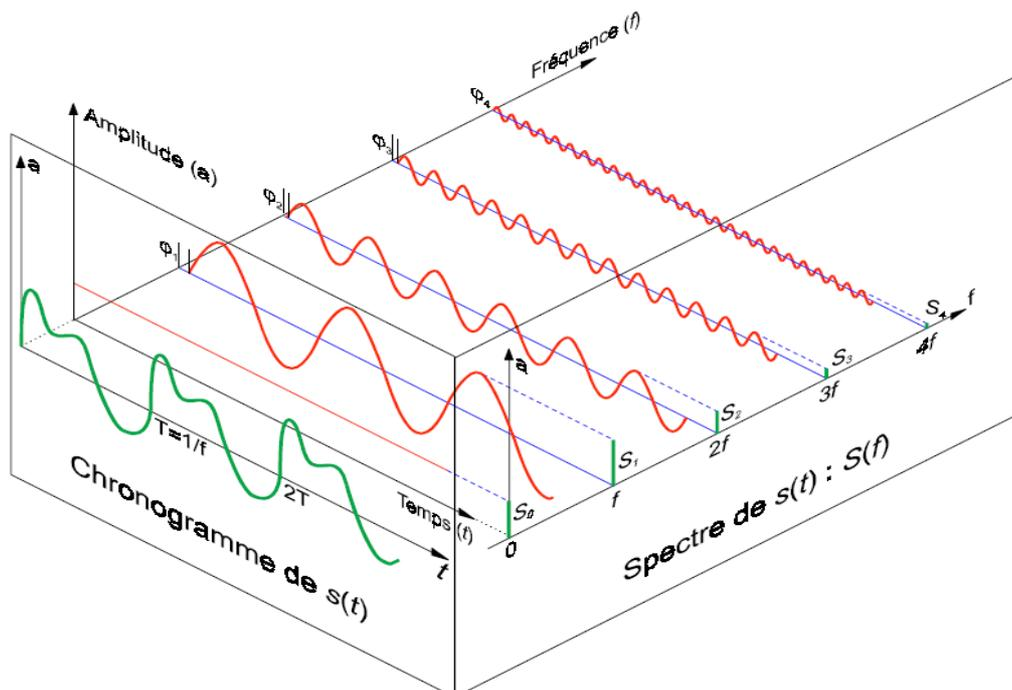
Un signal électrique quelconque peut être décomposé par une somme de signaux sinusoïdaux plus une composante continue.
