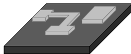
4) gravure et nettoyage de la résine. La couche non protégée par la résine est gravée, reproduisant le masque, puis la résine est éliminée
