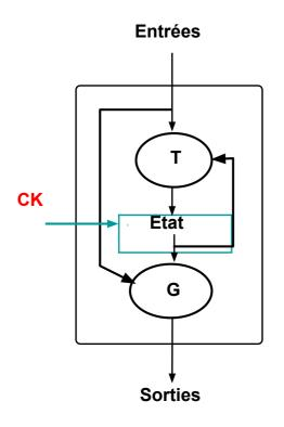
Tout système numérique synchrone peut être modélisé par un automate :
