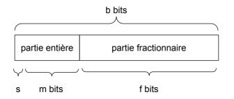
Exemple de codage sur 8 bits : 1-3-4 1 bit de signe 3 bits de partie entière 4 bits de partie fractionnaire
