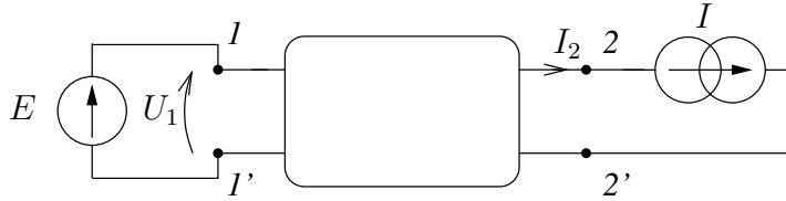
FIG. 22 – Quadripôle dont les valeurs des deux grandeurs externes sont imposées. Les deux autres sont en dépendance linéaire de I et de E .
