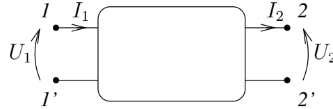
FIG. 21 – Symbole d’un quadripôle et sens conventionnel positif des courants et des tensions.
